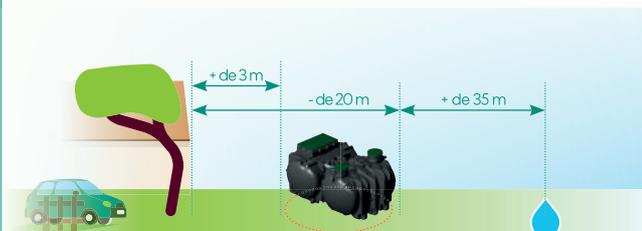
\* L'installation d'un bac à graisses est obligatoire si la distance est supérieure à 10 mètres.
