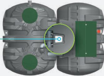
**⚠ Attention :** bien penser à introduire le remblai entre les deux cuves, dans l'espace prévu à cet usage. Si l'effluent doit subir une déviation angulaire en entrée ou sortie, utiliser des coudes à 45°.
