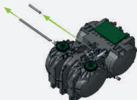
**2 Retirer** les barres de liaison en haut et en bas (utiliser une masse si nécessaire)
