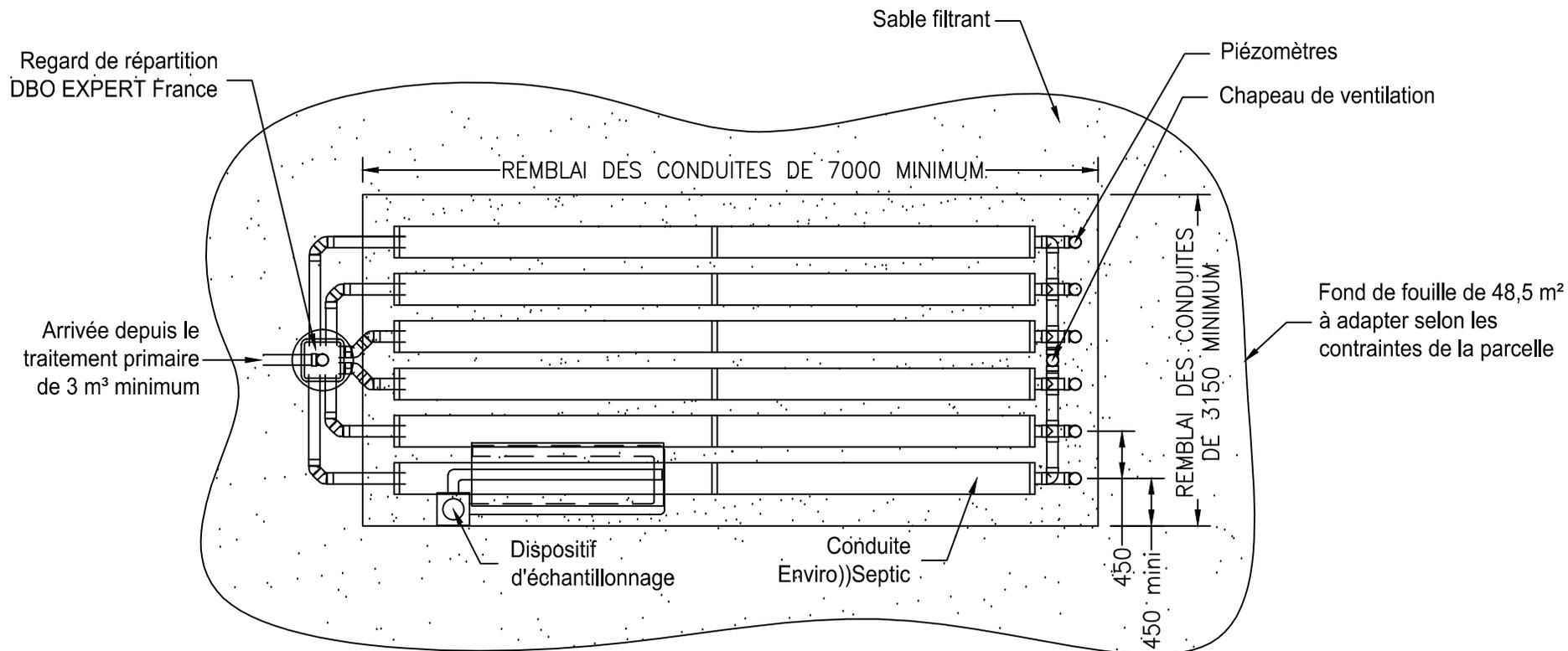
Pour ES5EH ND, la surface du fond de fouille doit être de 48,5 m<sup>2</sup>.
