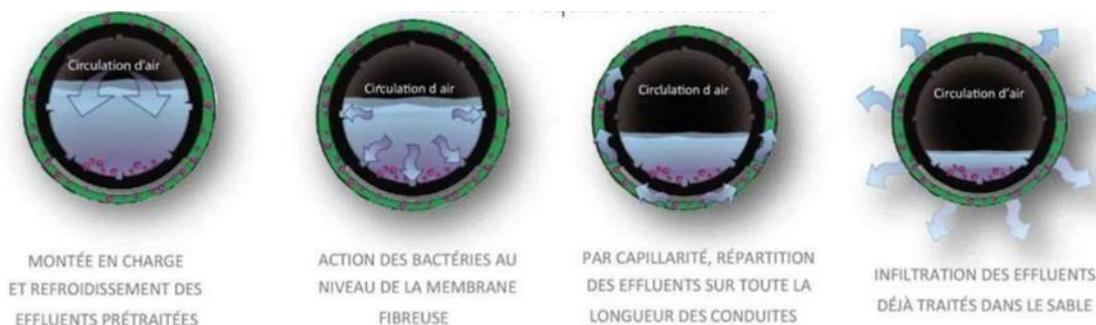
**ALTERNANCE DES BACTERIES AEROBIES ET ANAEROBIES POUR UN TRAITEMENT OPTIMAL**
