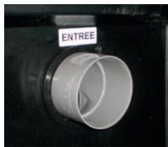
L'entrée et la sortie de la micro-station sont identifiées par des inscriptions (cf photos). La micro-station possède des manchons DN100 en entrée/sortie et est prête à être raccordée avec du tube PVC DN100.
