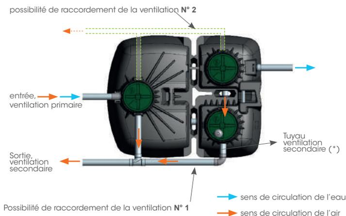
Le raccordement de la ventilation de la micro-station doit respecter le XP DTU 64.1.
